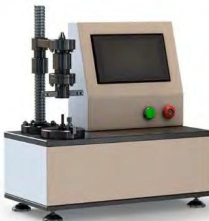
Рисунок 3. Автоматическое устройство для контроля моментов пружин
