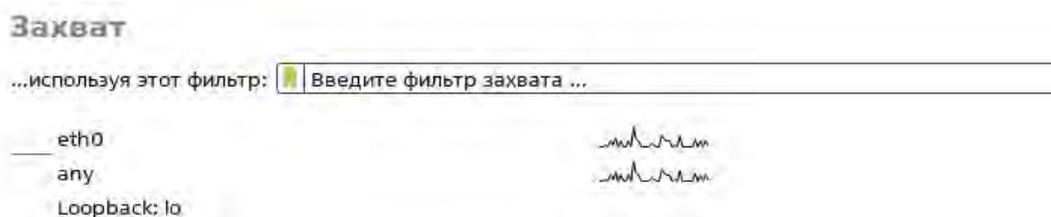
**Рисунок 3.** Интерфейсы и поле ввода фильтра захвата
