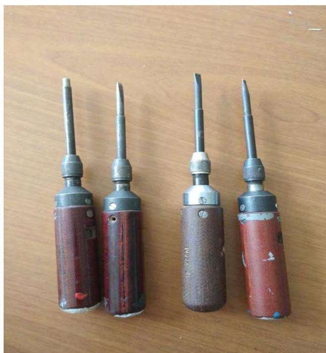
**Рисунок 5.** Динамометрические отвертки
